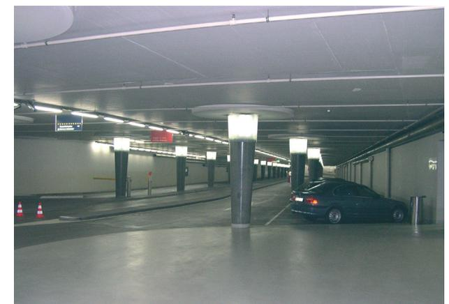
Aus der Portiersloge wird das gesamte Geschoss überwacht. Frauen und Behinderte können bei der Einfahrt die Begleitung des Portiers einfordern. Neben den punktuellen Stützenbeleuchtungen zeichnet eine gestrichelte Linie aus Neonröhren die Fahrtrichtung nach. Der Raum ist dadurch gut ausgeleuchtet.
