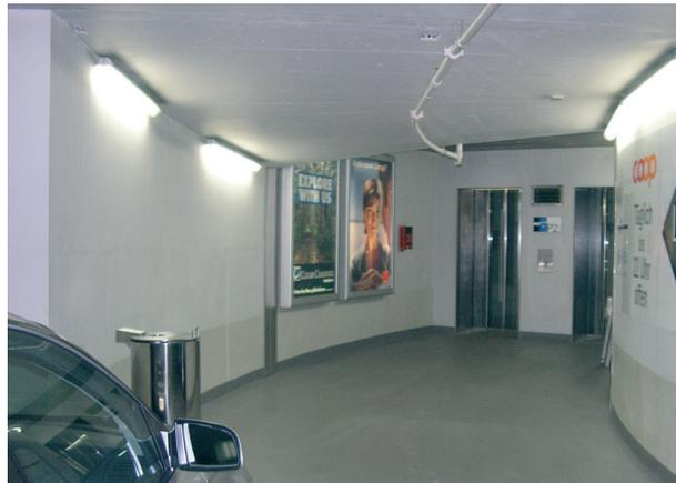
Ein Grossverteiler wird über einen kurzen einsichtigen Gang direkt von der Tiefgarage aus erschlossen. Bewusst wurde eine geschwungene Gangform gewählt, um Ecken und unübersichtliche Orte zu vermeiden. Auch hier grosszügige Lifte mit Glastüren. Die Beschriftung ist gross und aussagekräftig.
