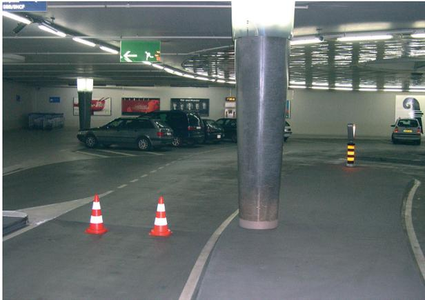
Im 1. Untergeschoss mündet die Einfahrt in einem Rondell, das als Bahnhofsvorfahrt für das schnelle Ein- und Aussteigen dient. Daran angegliedert sind Kurzzeitparkplätze um eine zentrale Mittelstütze gereiht. Diese trägt ein grosses Glasauge, welches Tageslicht in das Rondelle fallen lässt. Nachts haben die Gläser eine spiegelnde Wirkung. Sie werden von einem Neonkranz umgeben.
