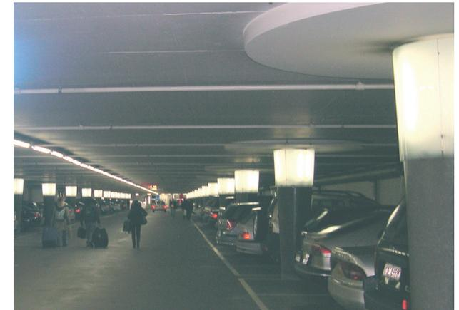
Die langen Hallen der drei Untergeschosse gleichen Alleen. Die Stützen mit ihrem Schaft aus Mattglas wurden im oberen Drittel mit Lampen hinterlegt. Eine runde darüberliegende Deckenplatte streut das Licht zusätzlich. Die Stützen mit ihren Lichtquellen rhythmisieren den Raum und lassen ihn fassbar und übersichtlich wirken.
